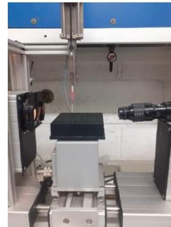
*Figure 15.* Porte échantillon (à gauche) et appareil de mesure de l'angle de contact (à droite).
