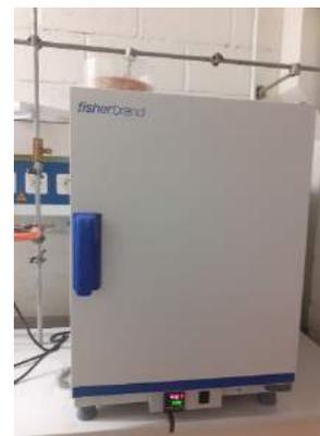
Figure 13. Étuve utilisée pour l'incubation des échantillons.
