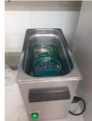
Figure 12. Solutions utilisées et nettoyeur ultrason.
